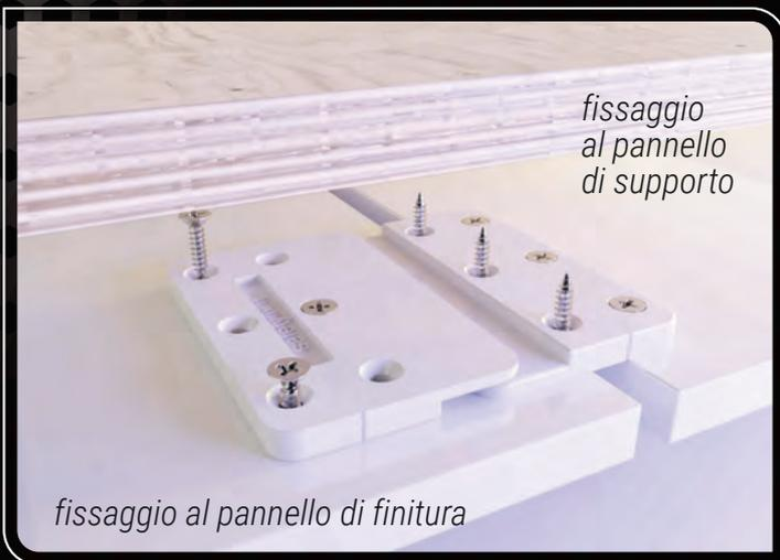
**Bajofix** consente un leggero movimento tra il pannello di supporto ed il pannello di finitura, per permettere la regolazione ideale dei componenti da installare. È caratterizzata da 6 fori svasati nelle due direzioni, che rendono il suo utilizzo estremamente flessibile. Inoltre la parte più sottile è anch'essa leggermente svasata, in modo da agevolare l'incastro tra i due elementi in fase di montaggio.
